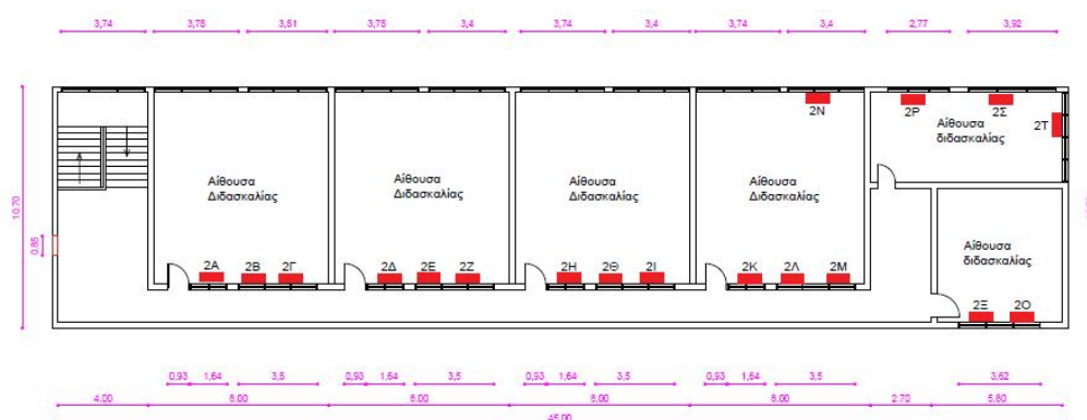
Θερμαντικά σώματα ορόφου
