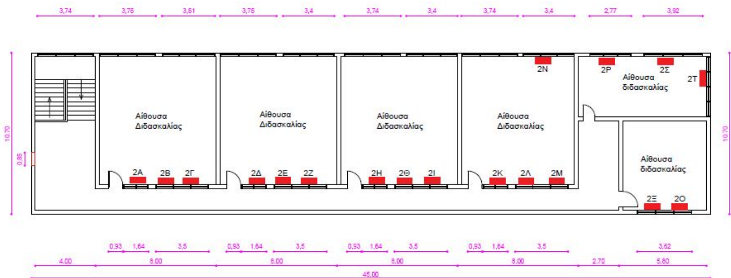
Θερμαντικά σώματα ορόφου
